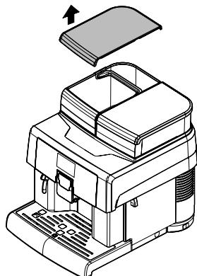
Достаньте бак; поднимите его при помощи специальной ручки, установленной внутри.
