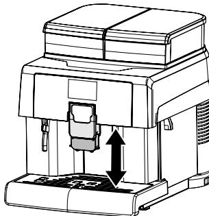
Для выполнения регулировки приподнимите или опустите вручную устройство подачи.
