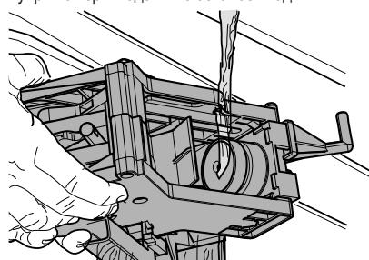
Приподнимите внутренний контейнер в задней части, чтобы отсоединить его.
