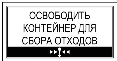
В этом случае машина не разрешает подачу кофе. Для восстановления работоспособности машины необходимо опорожнить контейнер для сбора отходов от отработанного кофе.
