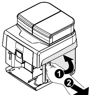
Достаньте блок приготовления кофе, для этого потяните за специальную ручку и нажмите кнопку «PRESS». Блок приготовления кофе можно мыть только теплой водой без моющего средства.
