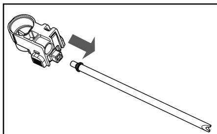
**6** Снимите штуцер с трубки.
