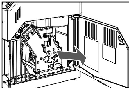
**4** Достаньте блок приготовления кофе, для этого потяните за специальную ручку и нажмите кнопку «PUSH». Блок приготовления кофе можно мыть только теплой водой без моющего средства.
