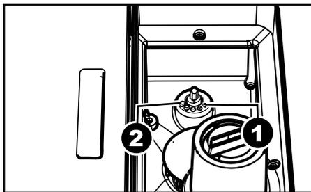
Метки указывают установленную степень помола; можно установить различные степени помола с помощью следующих меток:
