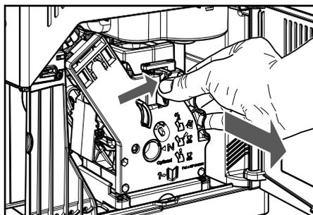
**5** Вымойте блок приготовления кофе теплой водой; тщательно промойте верхний фильтр. Перед тем как вставить блок приготовления кофе на место, убедитесь, что внутри камеры подачи не осталось воды.
