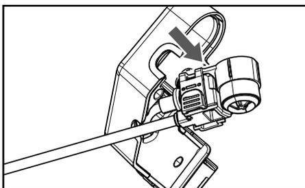
**3** Снимите нижнюю часть корпуса.
