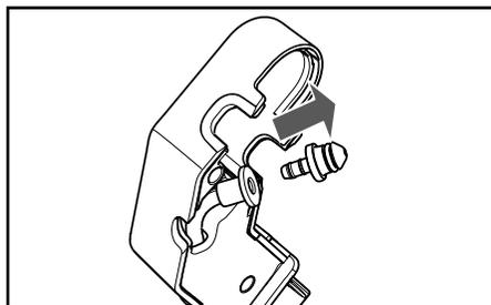
**5** Снимите трубку со штуцером.
