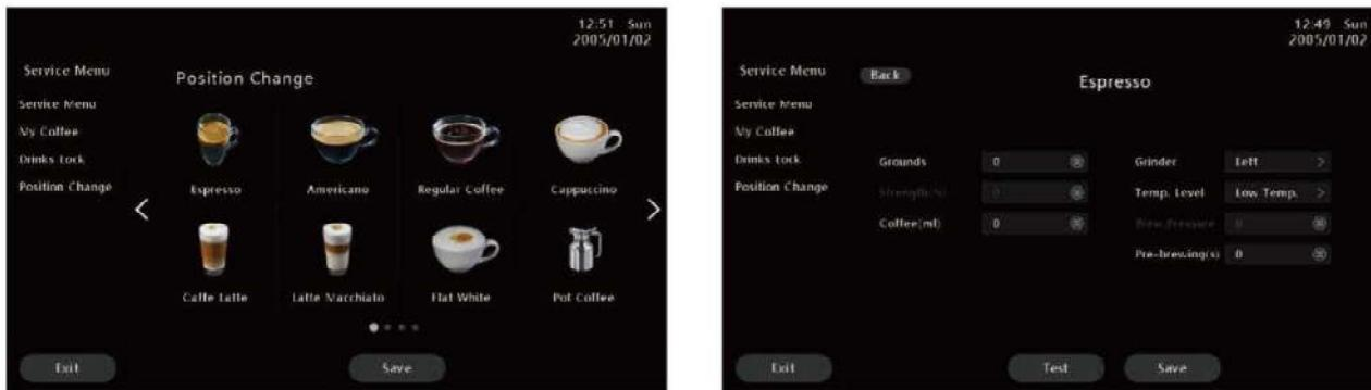
После изменения параметров можно нажать кнопку «Проверка» («Test») и приготовить пробный напиток.
