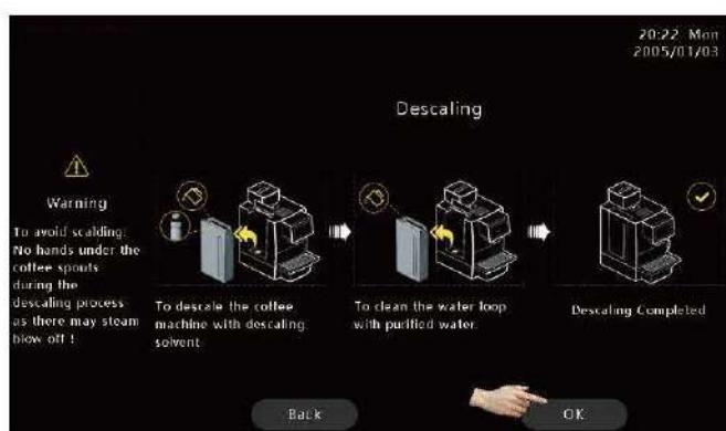
Шаг 6: Откройте дверцу, заполните резервуар для воды приблизительно до 2 л, засыпьте 1 пакетик порошка для удаления накипи (20 г) в бак, установите бак и закройте дверь. Нажмите на вкладку «OK» и перейдите к следующему шагу.
