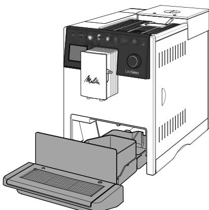
La bandeja de goteo se puede extraer de la máquina tirando hacia delante. La bandeja de goteo y el recipiente para posos de café se deben vaciar siempre a la vez. A continuación, hay que asegurarse de introducir
