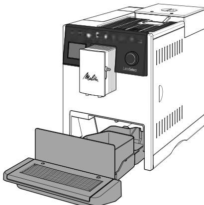
Поддон для сбора капель можно извлечь из аппарата, потянув его вперед. Всегда опорожняйте как поддон для сбора капель, так и емкость для кофейного жмыха. После этого убедитесь в том, что задвинули поддон в аппарат до упора.
