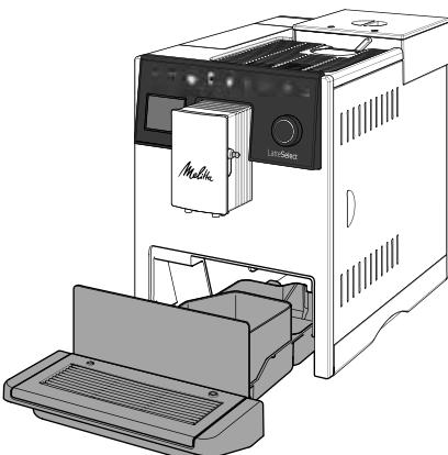
Dryppskålen kan trekkes fremover ut av apparatet. Tøm alltid både dryppskålen og grutbeholderen. Husk etterpå å skyve dryppskålen tilbake i apparatet inntil anslaget.
